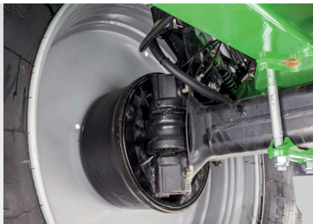
Regulación de la fuerza de frenado mediante el sistema electrónico de frenado (EBS)
