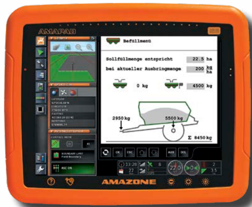
Menú de llenado. Determinación de la cantidad de llenado nominal
