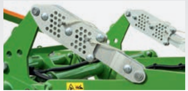
Ajuste mecánico de la profundidad de trabajo
