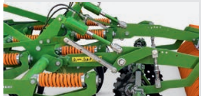
Adaptación automática de la unidad de nivelación
