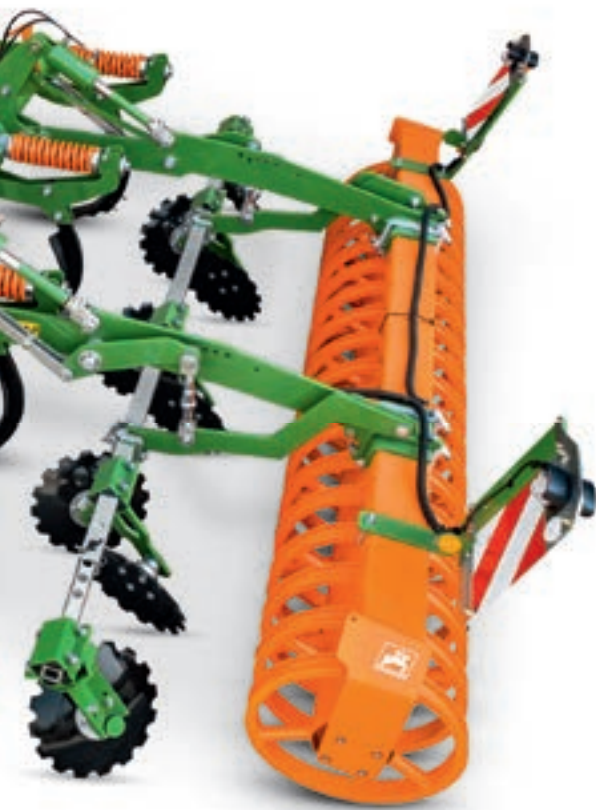
Ajuste hidráulico de la profundidad de trabajo con una escala clara
