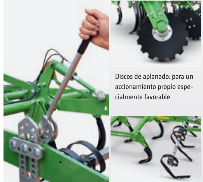
Ajuste manual de la unidad de nivelación mediante la trama perforada
