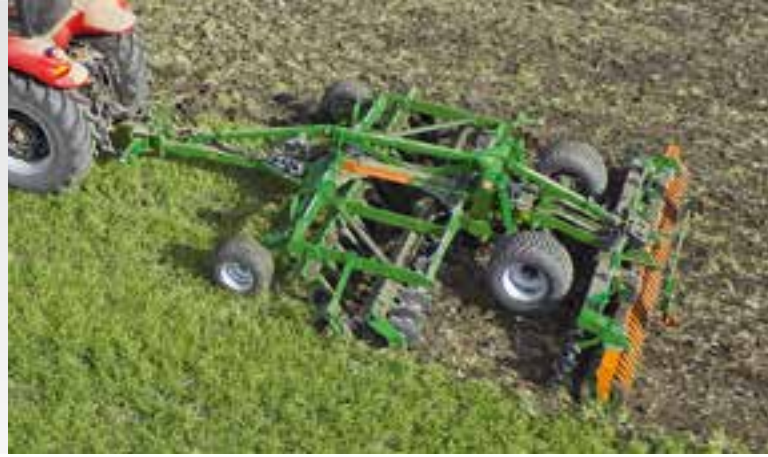
Certos 5001-2TX en una anchura de trabajo de 5 m
