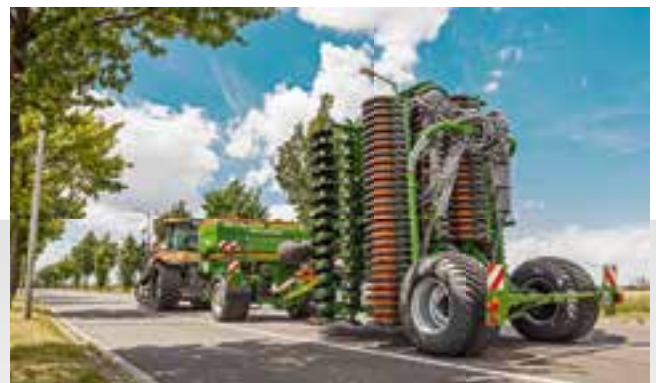
XTender-T 4200 con Catros + 12003-2TS para el transporte por carretera
