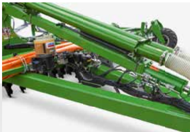
Sistema de lubricación centralizada en la Catros + 12003-2TS
