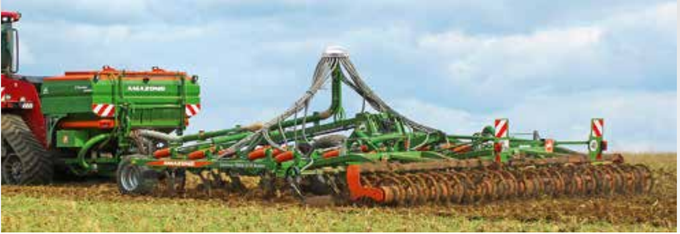
XTender 4200 con Cenius 6003-2TX y una unidad de arrastre para esparcir abono
