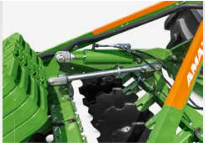
Ajuste hidráulico de la profundidad de trabajo
