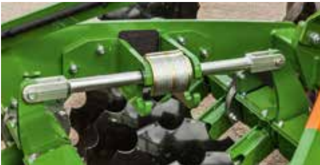
✔ Ajuste de la profundidad de trabajo mediante elementos distanciadores. En este caso, profundidad de trabajo superficial
