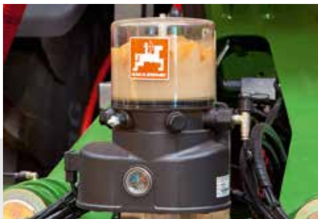
Bomba con depósito de reserva
