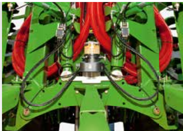
Sistema eléctrico de lubricación centralizada en la Catros, con paquete pro
