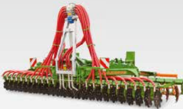
Esparcidor de abono semilíquido SynCult en la Catros + 6002-2 con paquete pro
