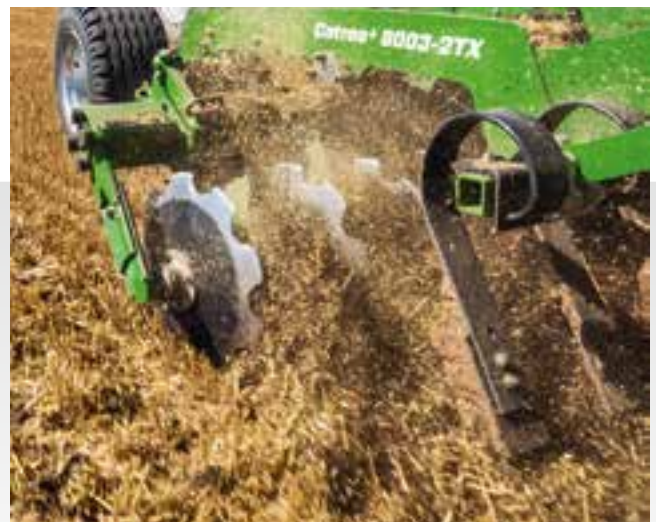
Crushboard con ajuste hidráulico de profundidad y una escala clara
