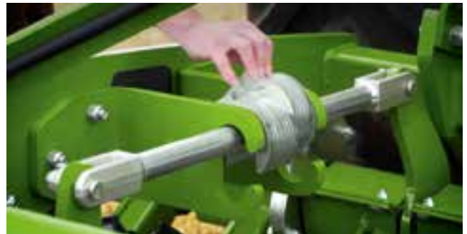
✔ Ajuste de la profundidad de trabajo mediante elementos distanciadores. En este caso, profundidad de trabajo media
