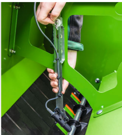
Cambio facilísimo de siembra fina a normal mediante la corredera de cierre
