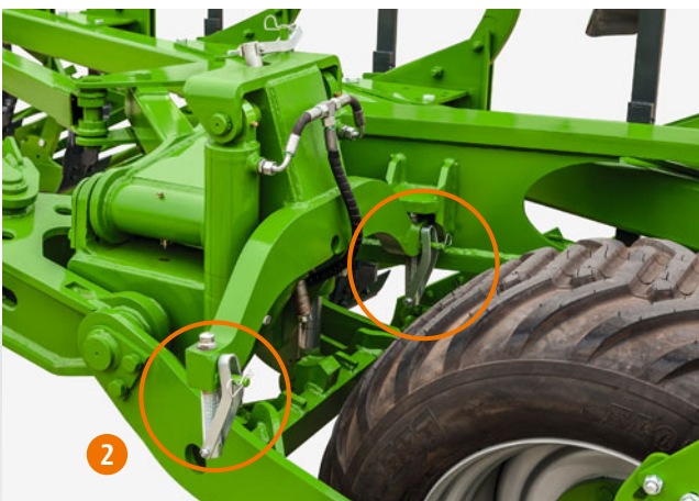
Ajuste del ángulo del arado
