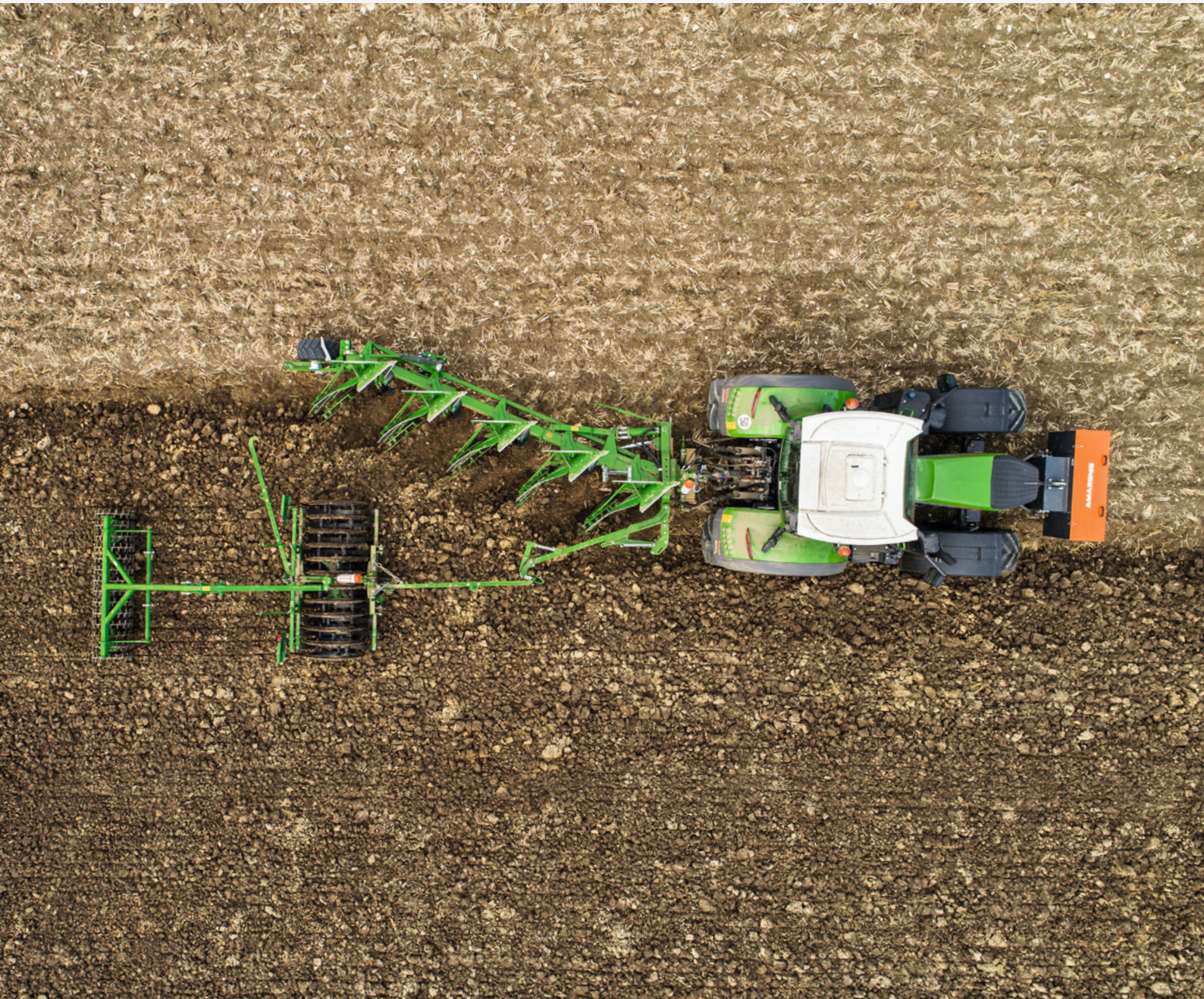
Cayros con brazo compactador montado, C-Pack 900 S y compactadora de anillos de levas 550
