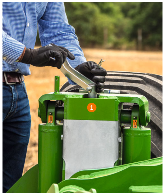
Ajuste de la profundidad de trabajo en la rueda del sistema semisuspendido
