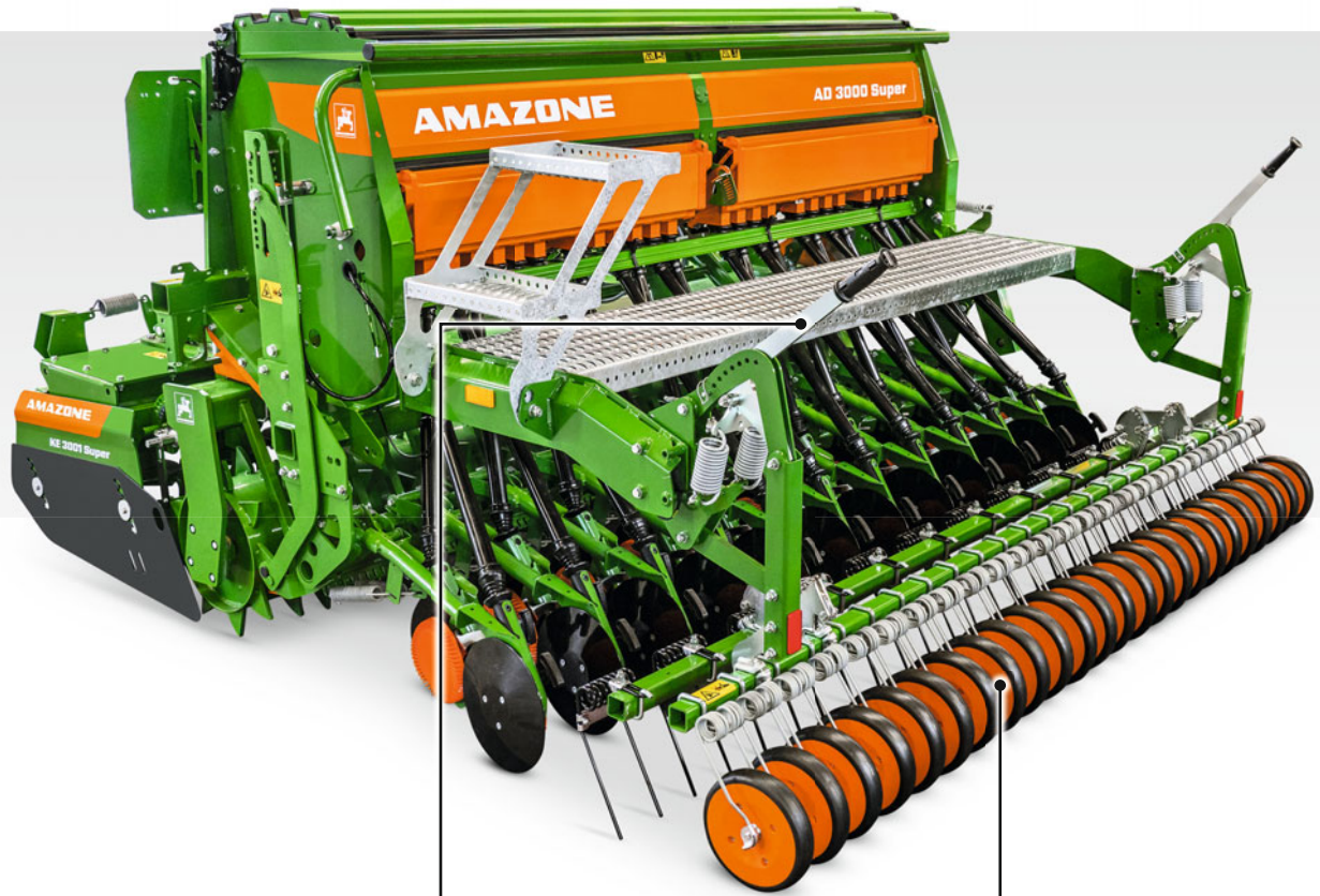
Ajuste mecánico de la presión de la rastra
