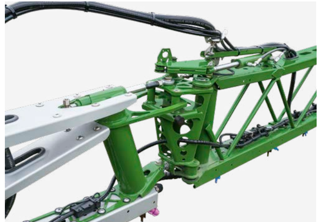
Articulación de desvío pretensada hidráulicamente en el pescante del extremo con principio de funcionamiento de puerta de saloon
