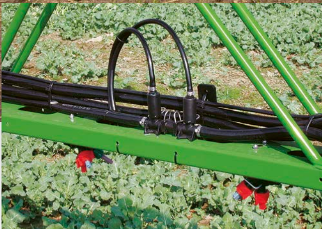
Sistema de circulación forzada (SCF)
