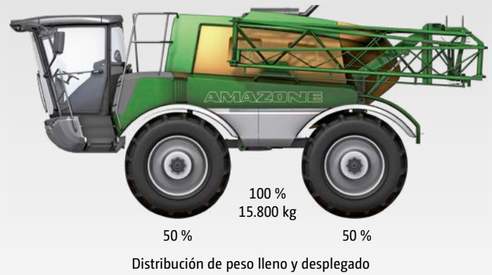
Pantera 4503, 24 m, 520/85R38, peso en vacío 9.850 kg
