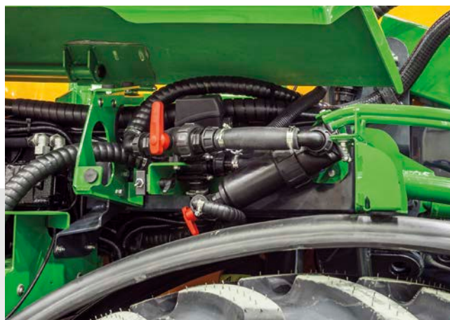
✔ HighFlow duplica la dosis de siembra máxima conectando las dos bombas en paralelo
