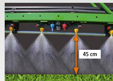
Boquillas 80°: Distancia entre boquillas 25 cm
