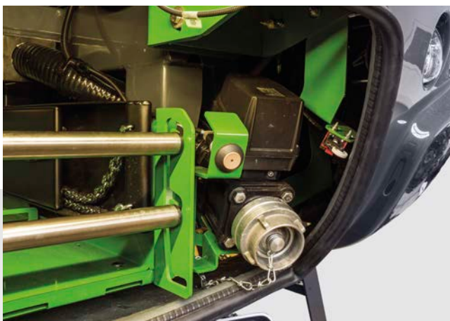
✔ Conexión de llenado en el compartimento portaobjetos con parada automática de llenado
