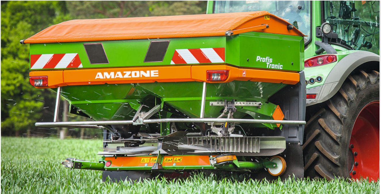
Dispersión en límite con Limiter V + activado
