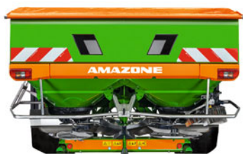
Depósito adicional S 2600 con escalera plegable
