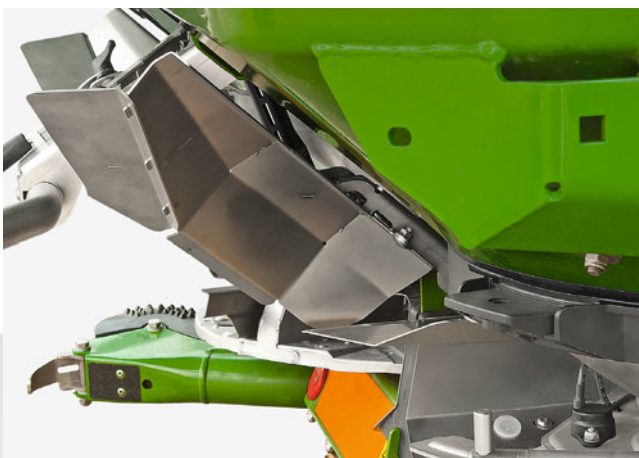
Panel de dispersión en límite levantado
